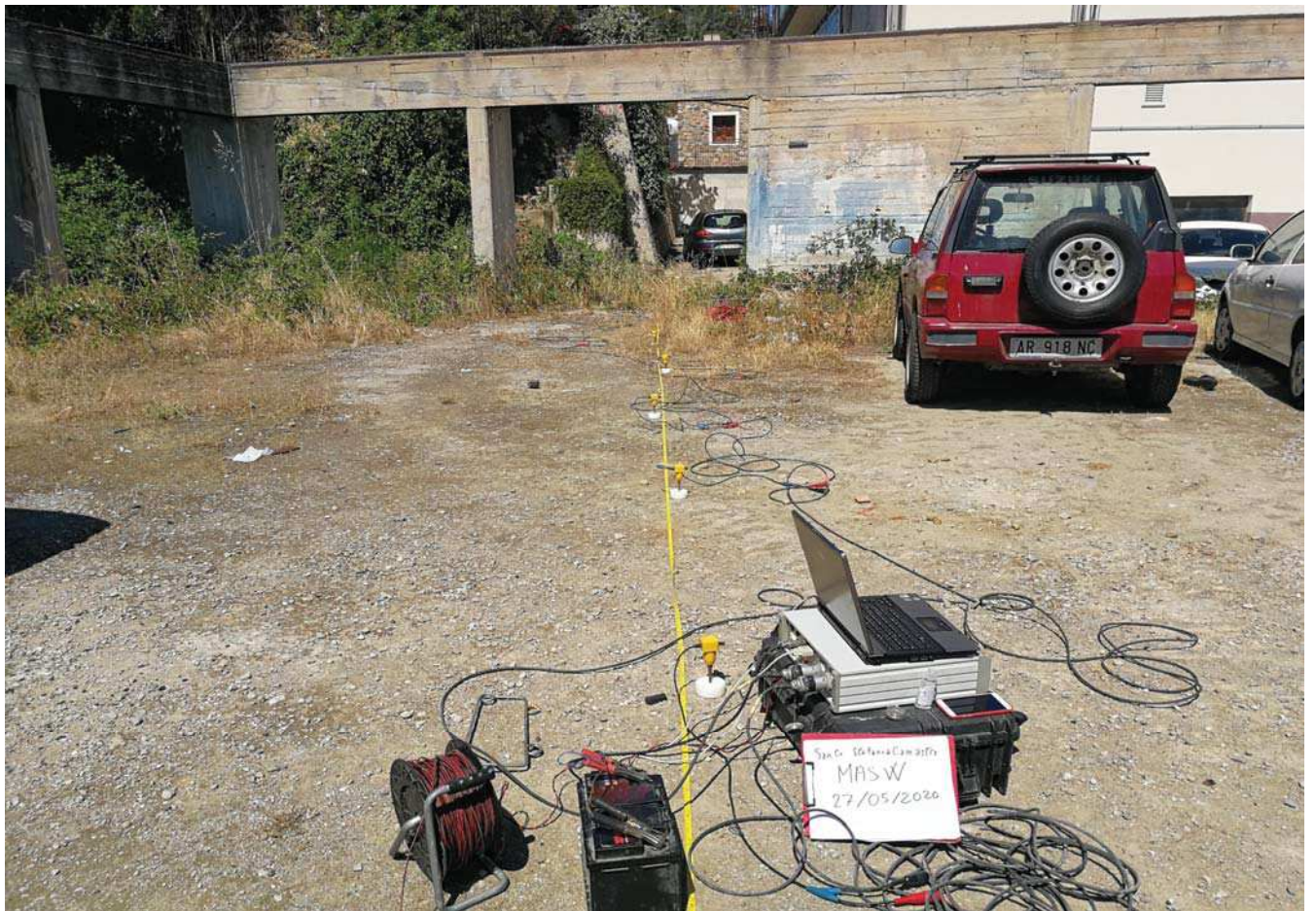
Stendimento sismico prova MASW
