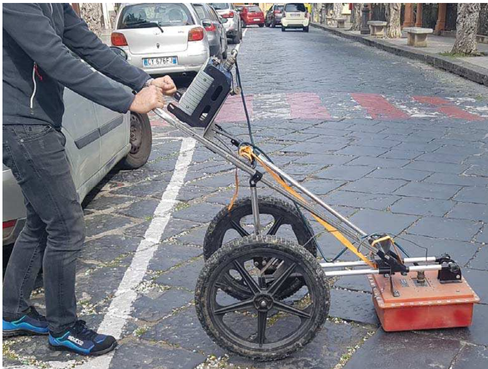
Strumentazione utilizzata - Georadar SIR 3000 - GS5I
