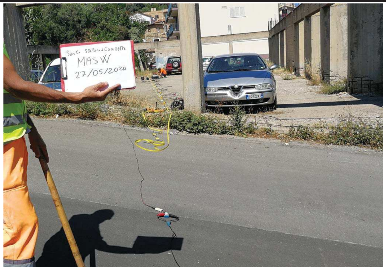
Stendimento sismico prova MASW
