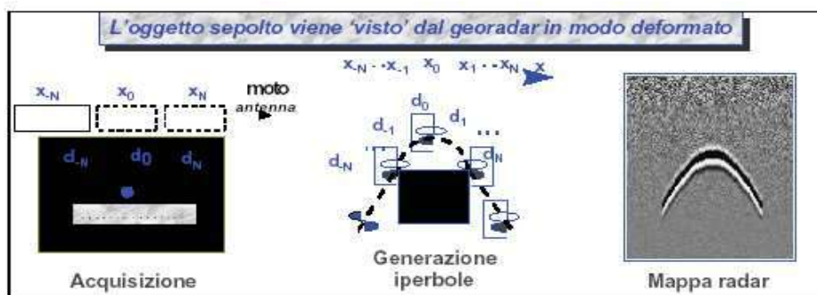
Fig. 1 - Principio di funzionamento del georadar
