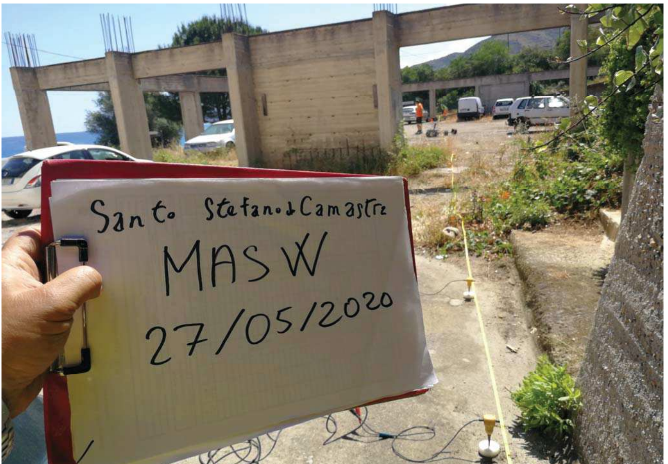
Stendimento sismico prova MASW
