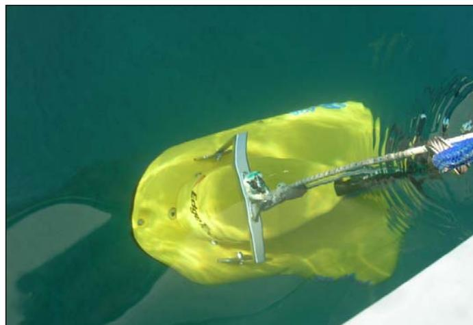
Fig. 5 - Installazione trasduttore S.B.P. a lato imbarcazione
