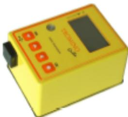
La misura di microtremore ambientale, della durata di 20 minuti, è stata effettuata con un tromografo digitale progettato specificamente per l’acquisizione del rumore sismico.
